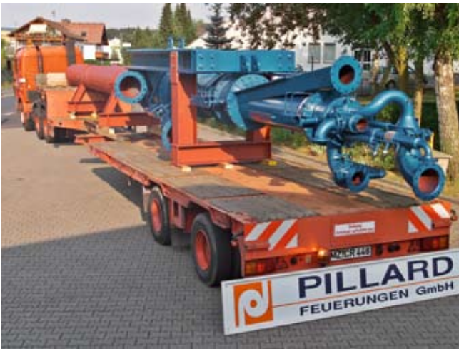
4 ROTAFLAM® WF – KGOS, 125 MW, für Petrolkoks, Rohöl, Schweröl, Erdgas, Altöl und feste alternative Brennstoffe 4 ROTAFLAM® WF – KGOS, 125 MW, for petrol coke, crude oil, heavy oil, natural gas, waste oil and solid alternative fuels
