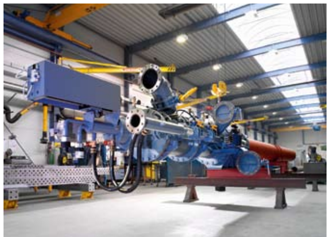
2 ROTAFLAM® GO, 72,2 MW, für Gas und Öl 2 ROTAFLAM® GO, 72.2 MW, for gas and oil
